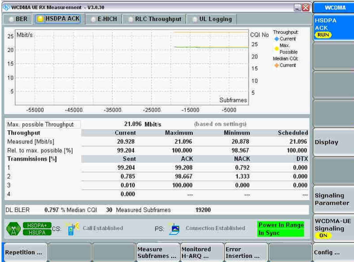
七、 对于没有配置 KS411 User Define Channel 功能的客户，还可以通过选择 Fixed Reference Channel 的 HSet-8 max throughput 信道来完成以上的信道配置
