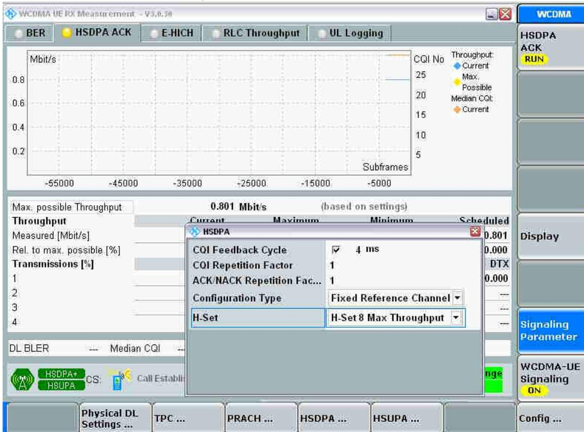
八、 上行吞吐率测试：选择同一界面下的 E-HICH 面板进行 HSUPA 上行吞吐率测试，可以通过 Signaling Parameter-HSUPA 来设置 HSUPA 参数，影响吞吐率的参数有：
