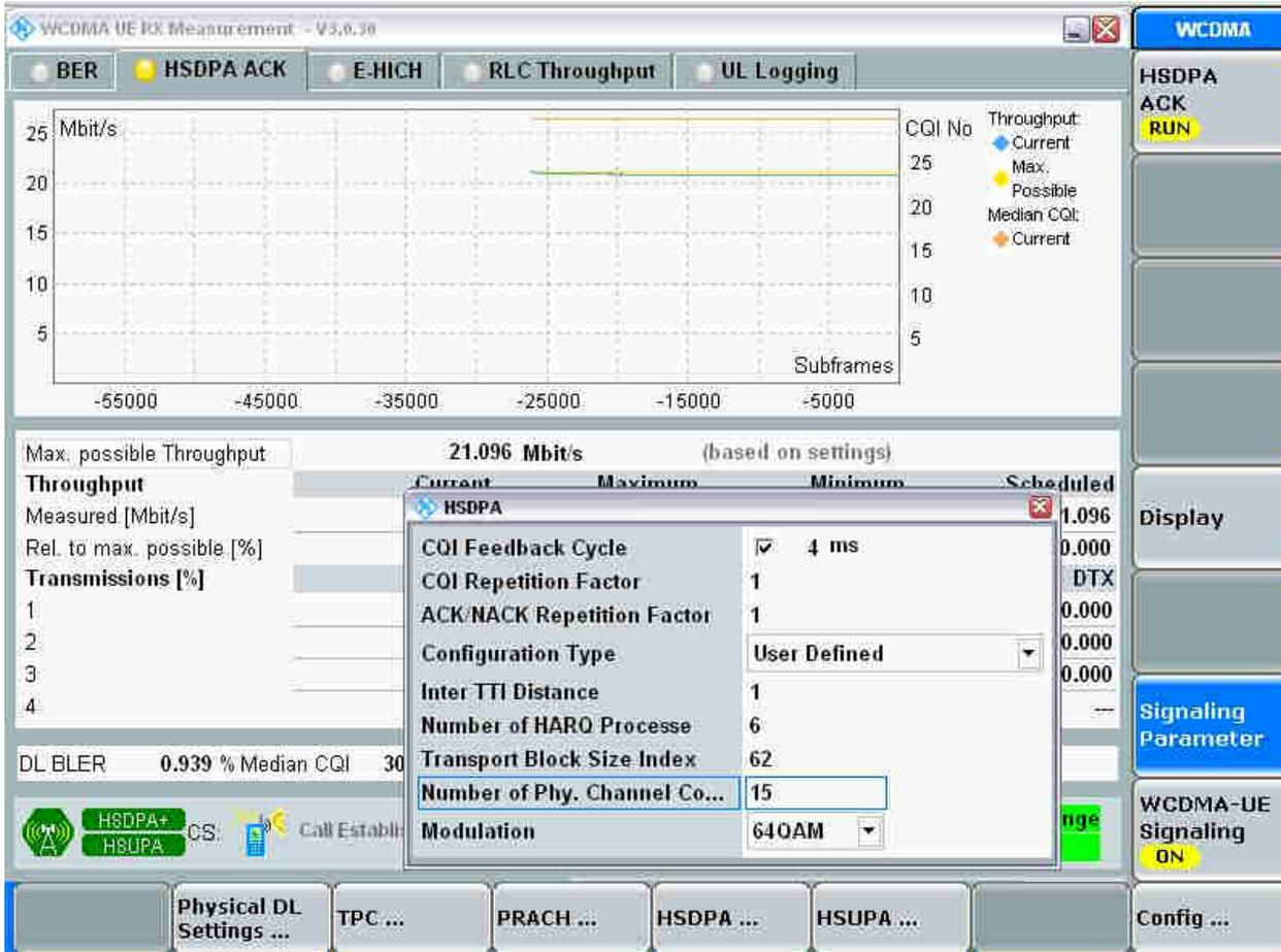
六、 下行最大吞吐率测试，设置完以上参数后，启动 HSDPA-ACK 测试即可测得最大吞吐率
